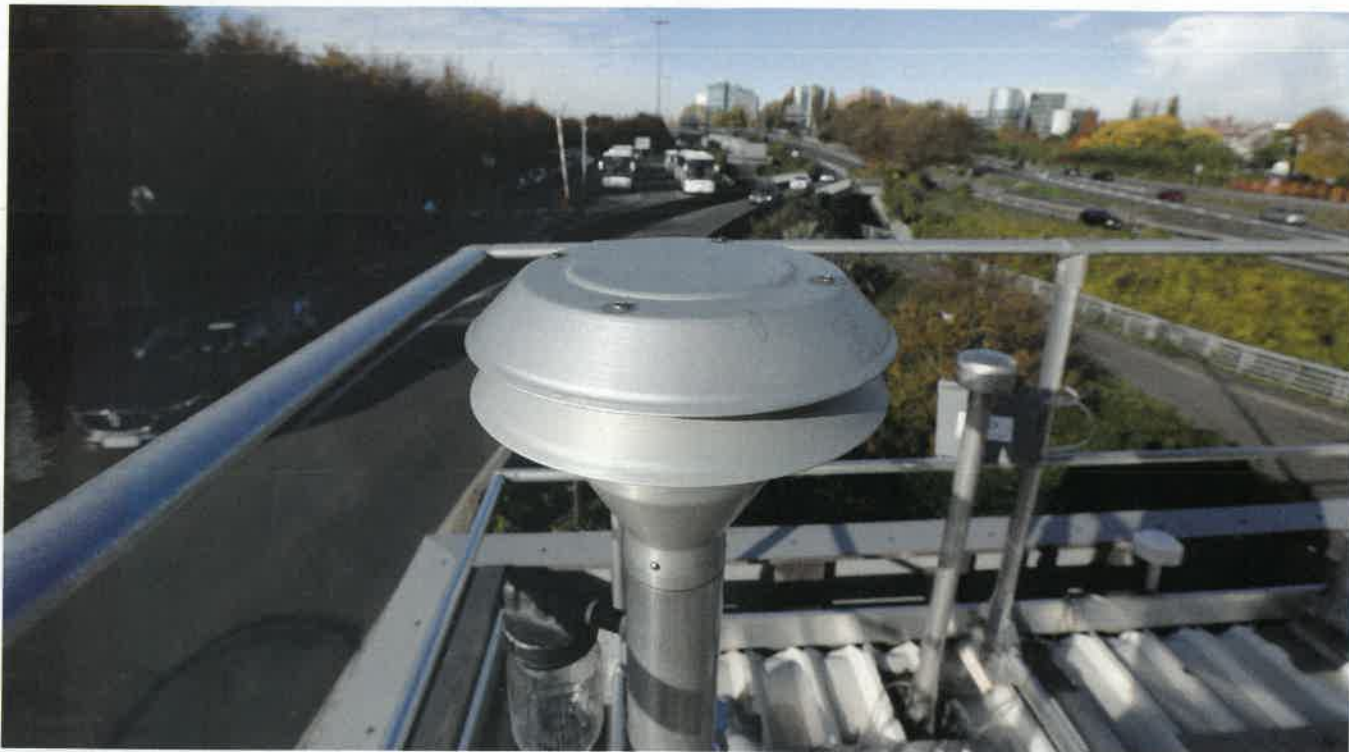
Sonde. Tête de prélèvement d'une station de l'Observatoire régional de l'air, qui mesure, 24 heures sur 24, les particules, les gaz et le carbone présents dans l'air.
